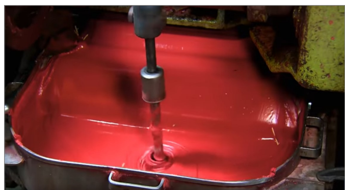
Préparation de la pâte, puis trempage et séchage des allumettes.
