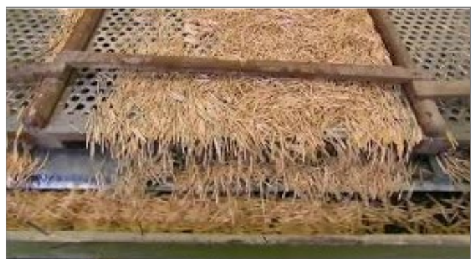
L'allumette (le tremble) est mélangé pour imprégnation.
