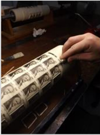
Découpe des rouleaux toucheurs-encreurs par un imprimeur taille-doucier, imprimerie de Philaposte à Boulazac © Alice Bigot /ATG 2020
