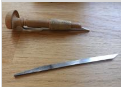
Lame non montée et non façonnée en bas, burin composé d'une lame façonnée en haut, atelier de Sarah Lazarevic © Alice Bigot /ATG 2020
