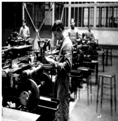
Atelier de clicherie taille-douce. Transfert poinçon/molette, 1985 © Musée de La Poste
