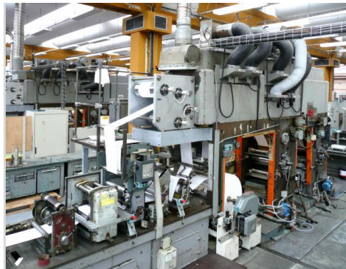
Vue d'une presse Taille-Douce 6 couleurs © Documentation imprimerie Philaposte de Boulazac
