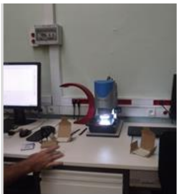
Scanner 3D, scan d'un poinçon gravé, clicherie, imprimerie de Philaposte à Boulazac © Alice Bigot /ATG 2020
