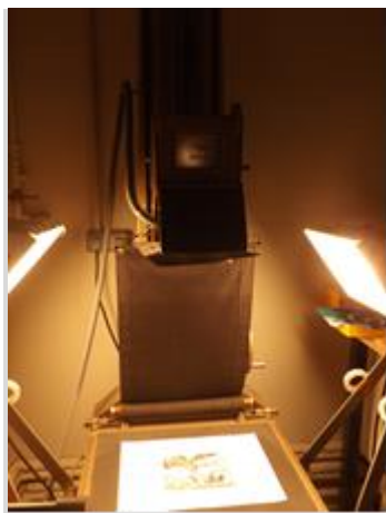
Réducteur photo et création du négatif, atelier de photo sur acier, imprimerie de Philaposte à Boulazac © Alice Bigot /ATG 2020
