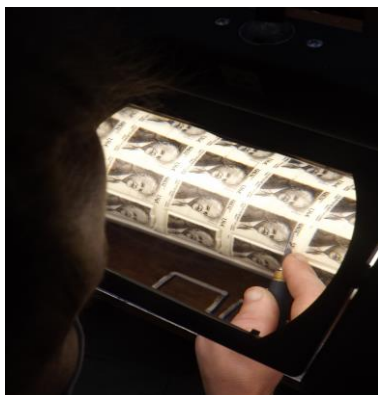
Imprimeur taille-doucier réalisant la découpe des rouleaux encreurs, imprimerie Philaposte à Boulazac © Alice Bigot /ATG 2020
